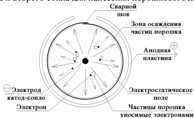
Рис. 3. Схема нанесения порошкового лака на внутреннюю поверхность корпуса банки
