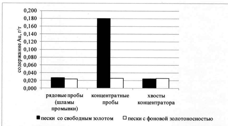
Рис. 2. Увеличение содержания извлекаемого золота в концентратных пробах из техногенных песков с фоновой убогой золотоносностью с использованием в процессе пробоподготовки лабораторного центробежного концентратора «ИТОМАК -0.1».
