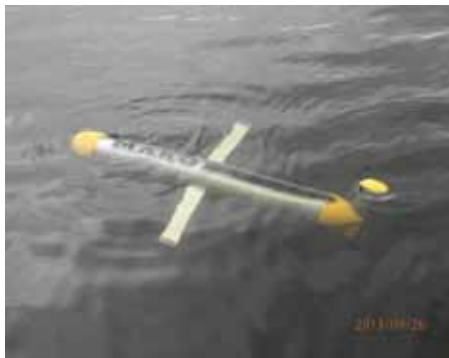
Рис. 1. Базовый архитектурно-конструктивный тип аппаратов разрабатываемого ряда – торпедообразный глайдер двухкорпусной схемы на испытаниях
