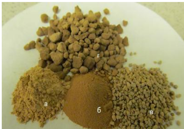
Рис. 7. Гидрофобные адсорбенты, полученные на основе шлама: а – исходный шлам, б – «СМ – 1», в – «СМ – 5», г – «СМ – 3»
