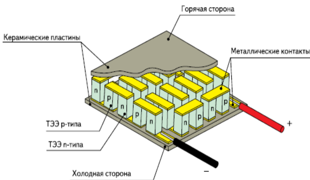
Рис. 3. Термоэлектрический генераторный модуль в разрезе
