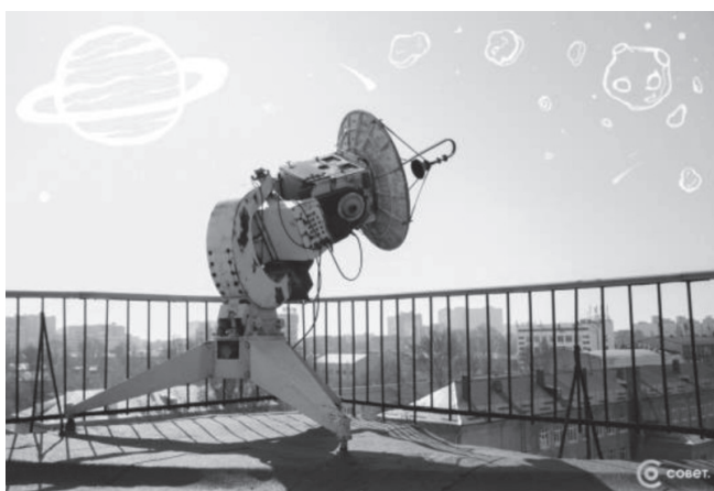
Рис. 3. Солнечный радиотелескоп с поляриметром, позволяющим измерять все параметры Стокса на частоте 8,9 ГГц
