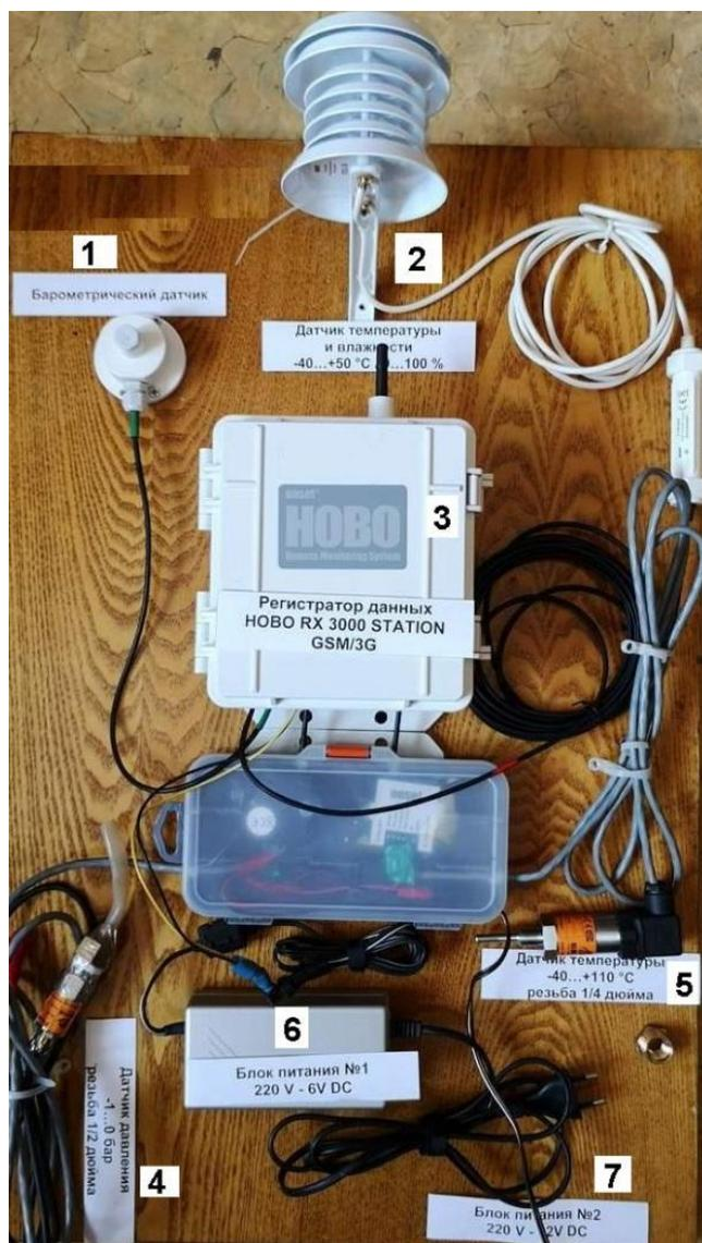
Рисунок 1 – Система дистанционного мониторинга на базе станции HOBO RX 3000:
