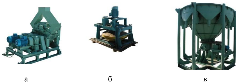
Рис. 1. а - дробилка комбинированного ударного действия ДКД-300, б - центробежный измельчитель ЦМВУ-800, в - пневмосепаратор ПОС-2000
