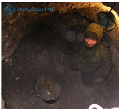
Рис. 1. Ручной подъем породы из шурфа, на примере АО «Алмазы Анабара»
