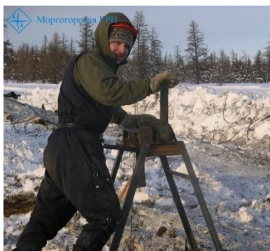
Рис. 1. Ручной подъем породы из шурфа, на примере АО «Алмазы Анабара»
