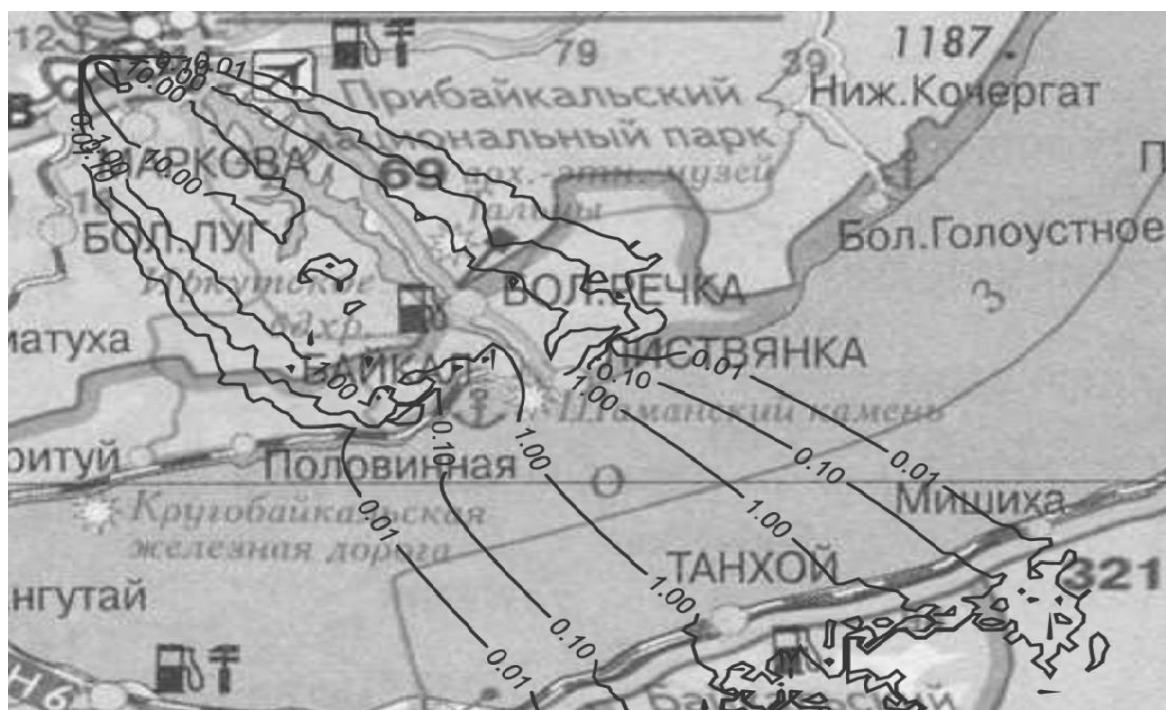
Рисунок 1. Изолинии рассчитанных приземных концентраций твёрдых взвесей в регионе Южного Байкала при северо-западном ветре, \text{мкг}/\text{м}^3 (источник выбросов – Ново-Иркутская ТЭЦ)
