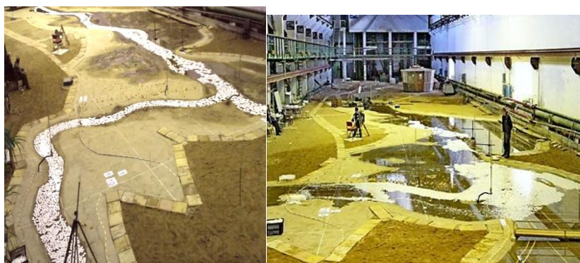
Рис. 4. Начало (слева) и конец (справа) эксперимента по формированию Аристовского затора
