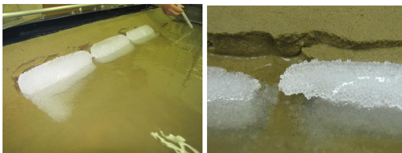
Рис. 1. Влияние потока на подводный размыв оттаявшего материала
