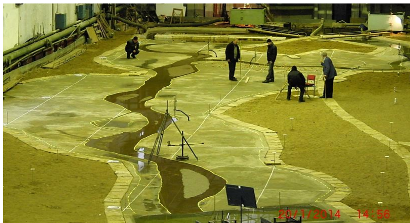
Рис. 3. Гидравлическая модель узла слияния рек (вид против течения)
