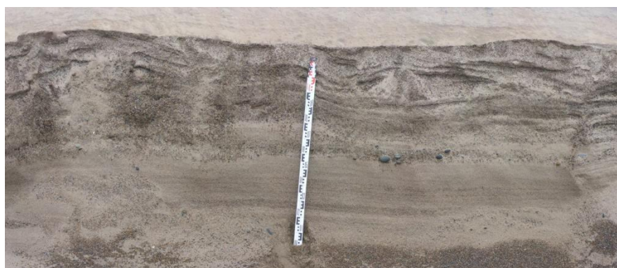
Рис. 4. Строение «оттаявших» пляжевых отложений сформированных в период наледиобразования
