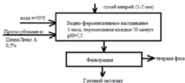
Рис. 2. Схема получения экстракта водно-ферментативным настаиванием в одну стадию
