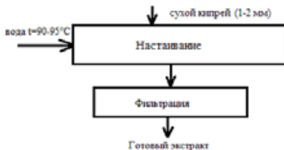
Рис. 1. Схема получения экстракта завариванием
