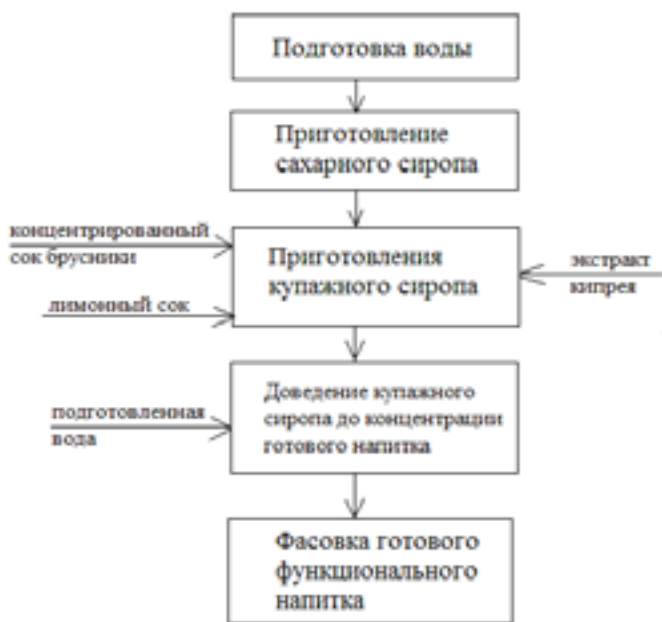
Рис. 4. Технологическая схема производства функционального негазированного безалкогольного напитка на основе экстракта кипрея с применением ферментных препаратов
