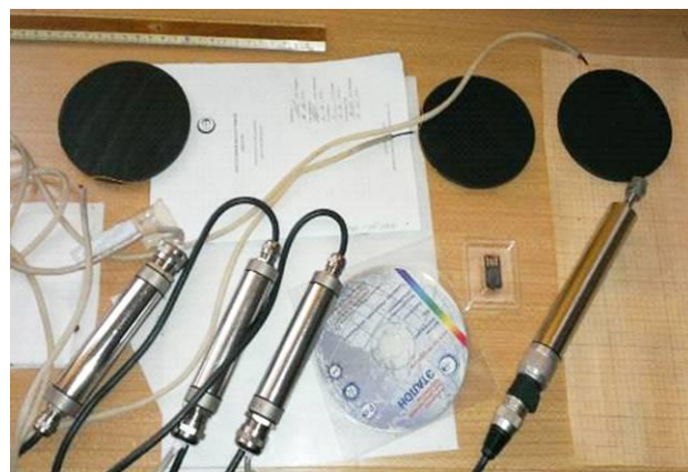
Рис. 9. Система измерения тепловых потоков в грунтах
