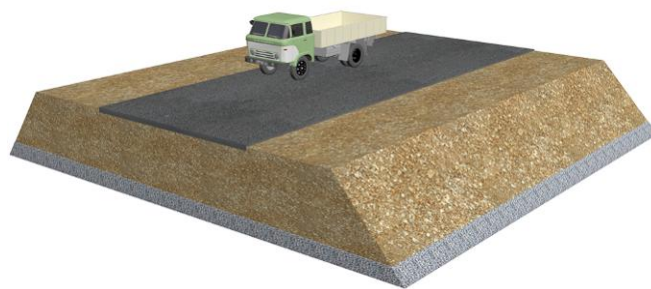
Рис. 3 Дорожная конструкция со слоев ГТМ «ДиатомИК» в основании
