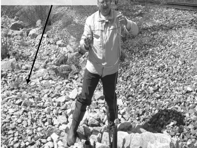
Рис. 5. Погружение логгера и термокосы в скважину № 6, май 2013 г., «Км 2339» перегона Курьян-Тында
