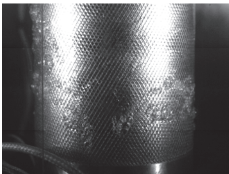
Рисунок 1: Теплоотдающая поверхность с трехмерной структурой ромбовидной формы.
