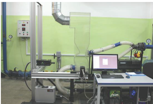
Рисунок 1: Экспериментальный стенд для исследования аэродинамики в вихревой топке нового типа
