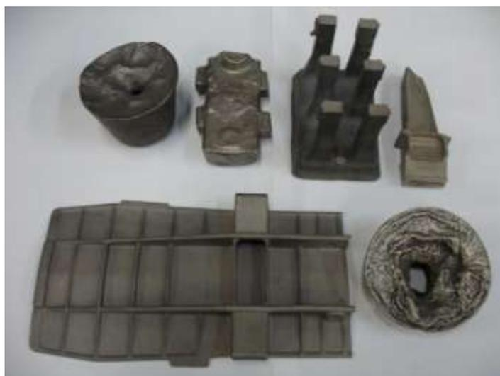
Рис. 1 – Кондиционные отходы литейных жаропрочных сплавов
