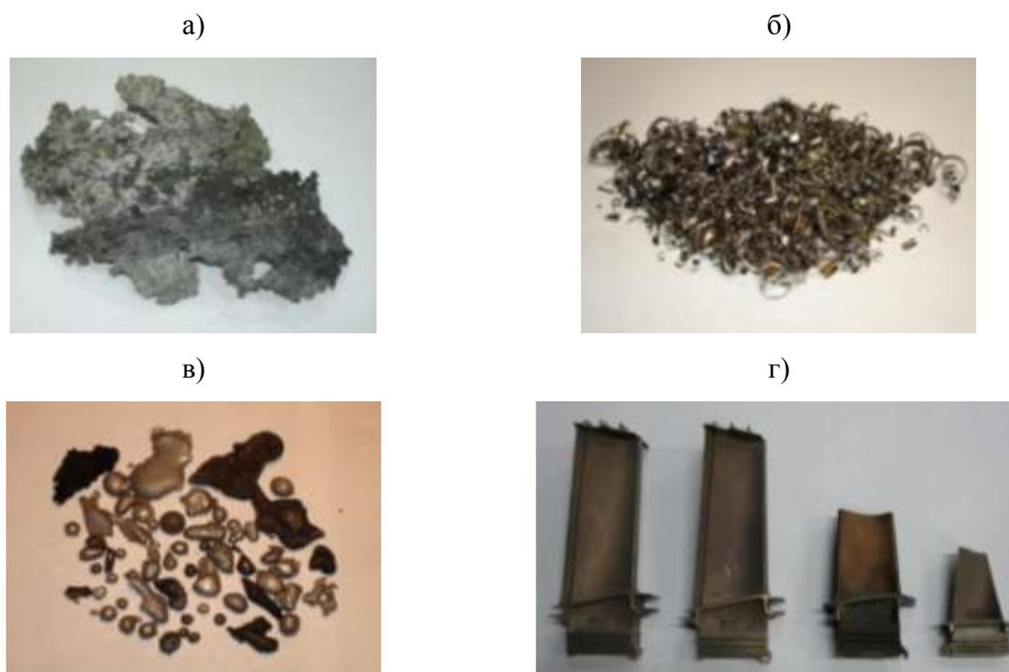
Рис. 2 – Некондиционные отходы литейных жаропрочных сплавов:
