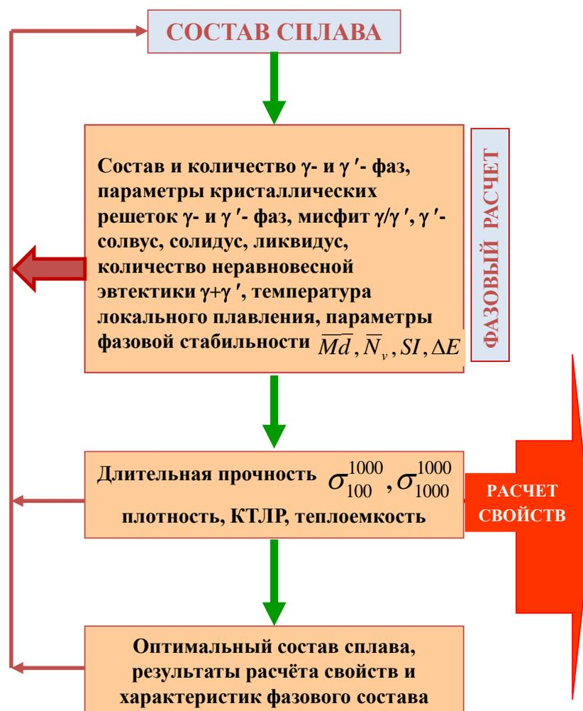
Рис. 5 – Схема метода компьютерного конструирования жаропрочных никелевых сплавов
