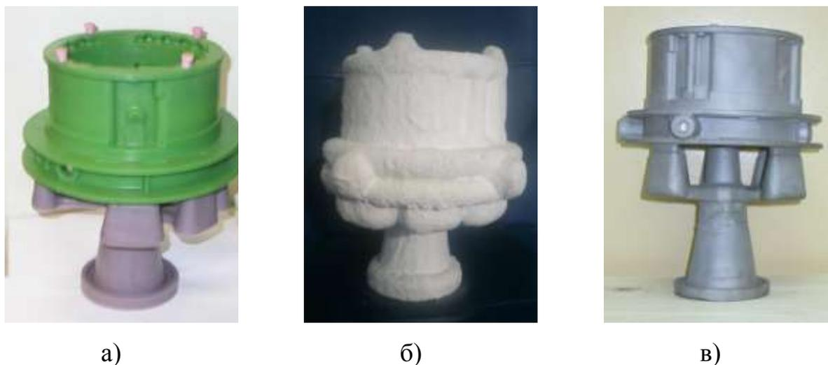
Рис. 8 - Модель детали с ЛПС (а), керамическая форма (б), отливка детали «диффузор» (в)
