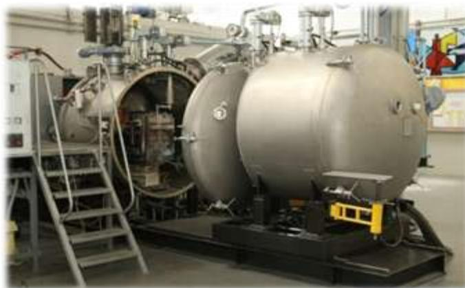
Рисунок 1 – УВНС-6 – промышленная высокоградиентная установка (градиент до 200 °С/см) для литья деталей длиной до 300 мм с монокристаллической структурой
