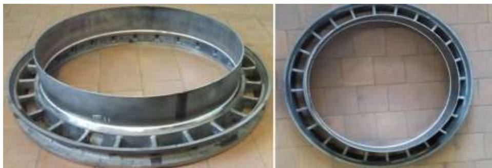
Рис. 15 - Внешний вид сварного соединения отливки детали диффузор из сплава ВЖ172Л и листовой обечайки из сплава ВЖ172, выполненного ЭЛС
