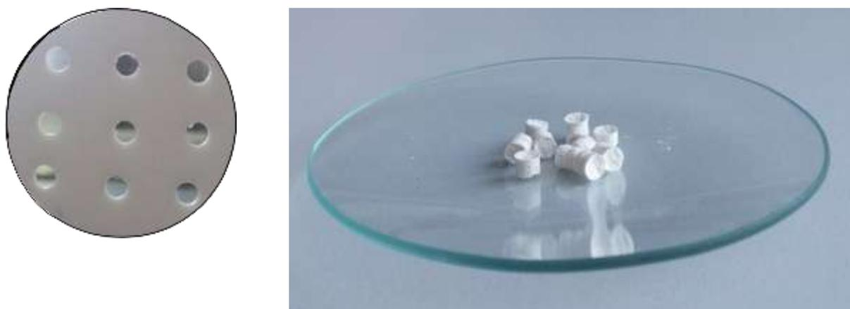
Рис.3 – Фторопластовая матрица и керамические таблетки
