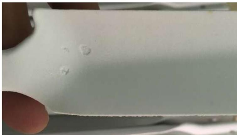
Рис. 4 – Вспучивание участков стержня после обжига
