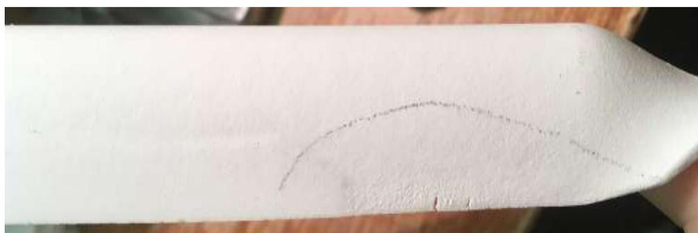
Рис. 3 – Образование повышенной шероховатости после обжига
