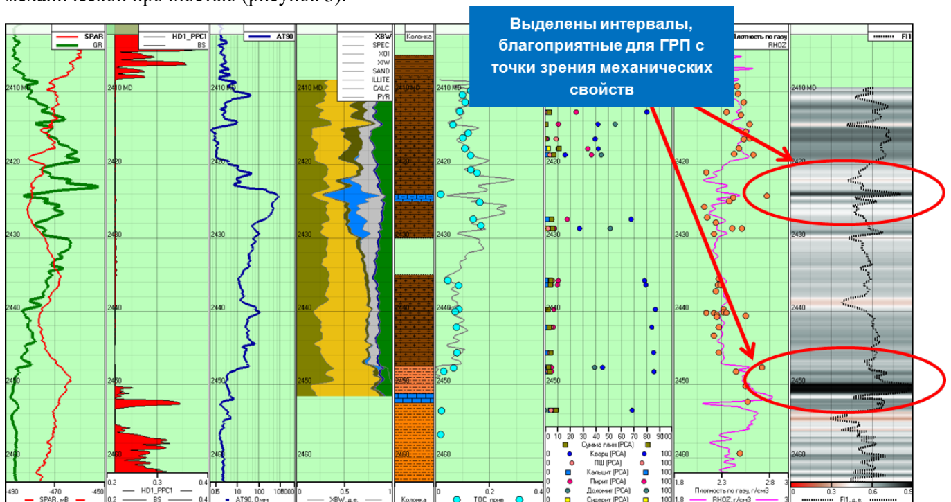
Рисунок 3. Выделение в разрезе БС наиболее благоприятных интервалов проведения ГРП и зон «поглощения» трещин с точки зрения механических свойств
