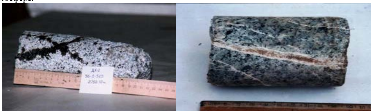
Рисунок 1. Нефтенасыщенные образцы керна кристаллического фундамента месторождения Дайхунг шельф Южного Вьетнама
