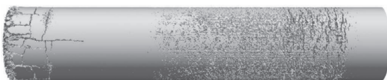
Развитие разрушений в цилиндре из силикатного стекла при динамическом воздействии.
