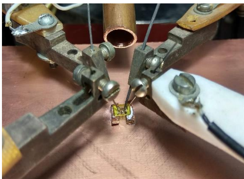
а б Рис. 1. а) фотография макета алмазного датчика расхода воздуха; б) компьютерная модель, использованная в расчетах
