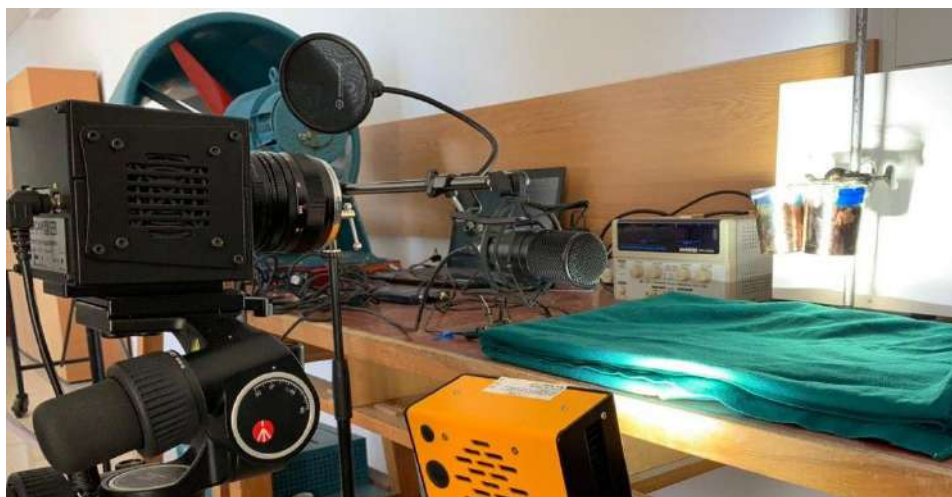
Рис. 3. Экспериментальная установка. Съёмка на камеру до 80 тысяч кадров в секунду, запись звука с частотой дискретизации 44,1 кГц, запись сигнала с осциллографа при соударении с частотой дискретизации до 100 МГц.
