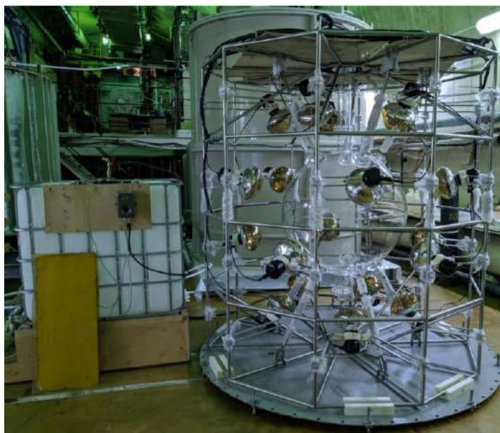
Рис. 10. Каркас с установленными на нем ФЭУ и сферой. На заднем фоне резервуар с водой, в который помещается каркас
