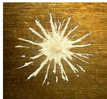
Рис. 2. Фотография автографа, образованного на поверхности медного анода за один импульс облучения. Диаметр эрозийной фигуры 7 мм
