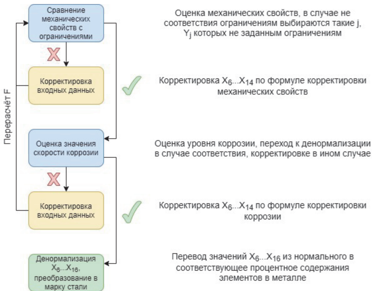
Рисунок 2 – Алгоритм оптимизации целевой функции
