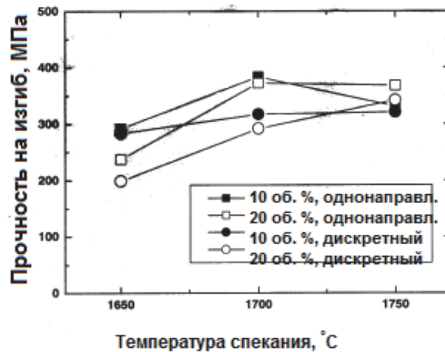
Рисунок 4 – Прочность на изгиб SiC-композитов, армированных дискретными SiC-волокнами при горячем прессовании
