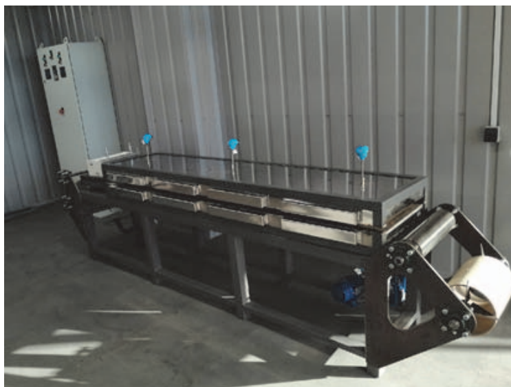
Рисунок 1 – Внешний вид лабораторной для формирования керамических препрегов в виде лент методом полива
