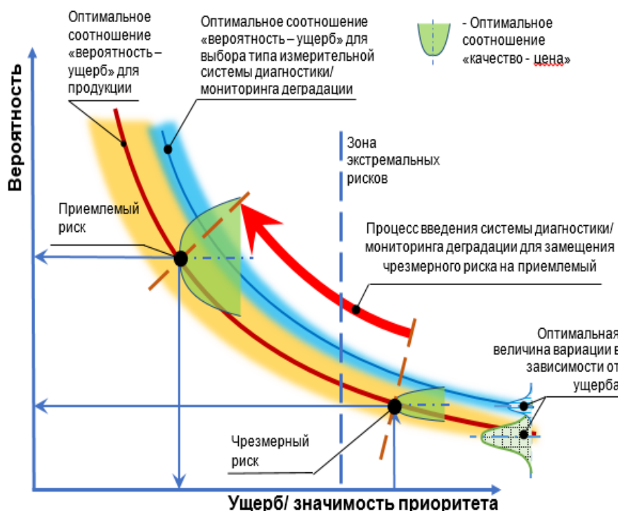
Рис.4. Модель оптимизации рисков введением системы диагностики/ мониторинга деградации
