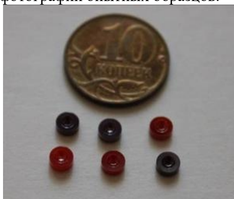
Рис. 2. Экспериментальные подпятники, изготовленные из кристаллов ЧСЦ
