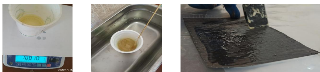
Рис. 1. Подготовка полимерного связующего, добавление нанопорошков
