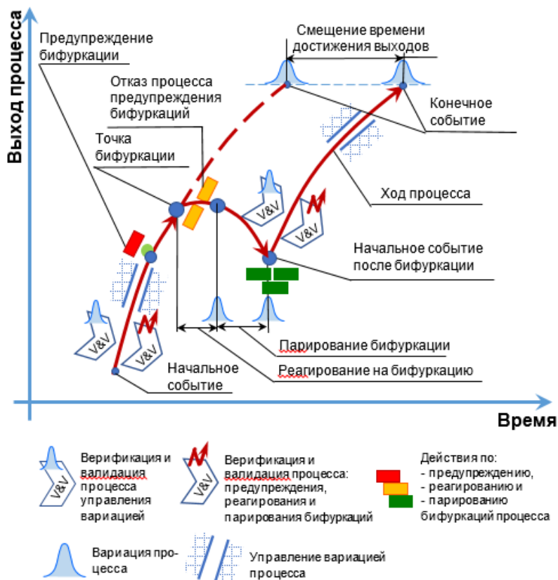
Рис.3. Структура управления рисками процесса методами предупреждения и парирования с учетом вариации и бифуркации
