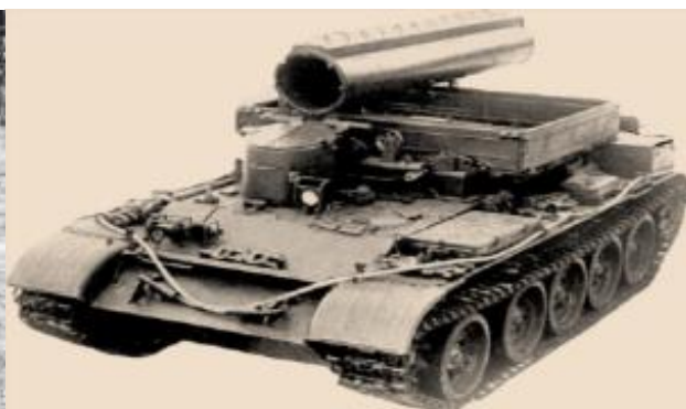
Рисунок 1. Танковые тягачи: а) БТС-2, б) БТС-4
