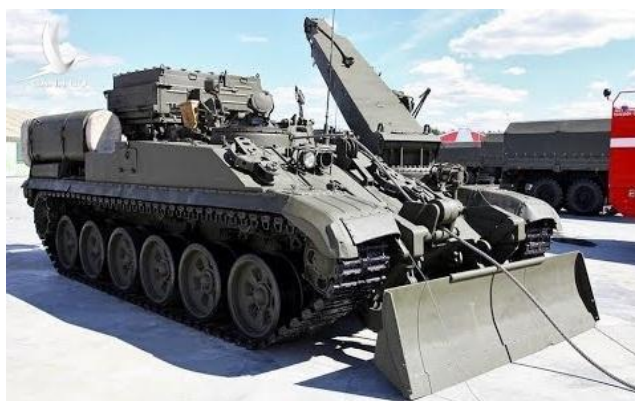
Рисунок 3. Модернизированный вариант на базе танка Т-90 БРЭМ-1М, б) Т-90
