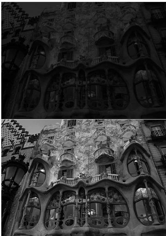
*Рис. 36. Пример результата применения операции гамма-коррекции для расширения динамического диапазона (а – исходное изображение; б – после коррекции)*
